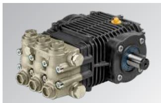
Nuova pompa CL 6.0 autoadescente a tre pistoni in ceramica integrale, cuscinetti a rulli conici, doppio visore olio, testata in ottone nichelato e guarnizioni acqua per alte temperature
